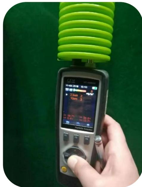
风管末端 PM2.5 数值为  $2\mu\text{g}/\text{m}^3$
