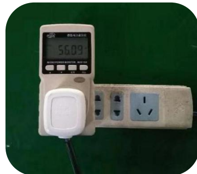
高档运行耗电量：56.09W
